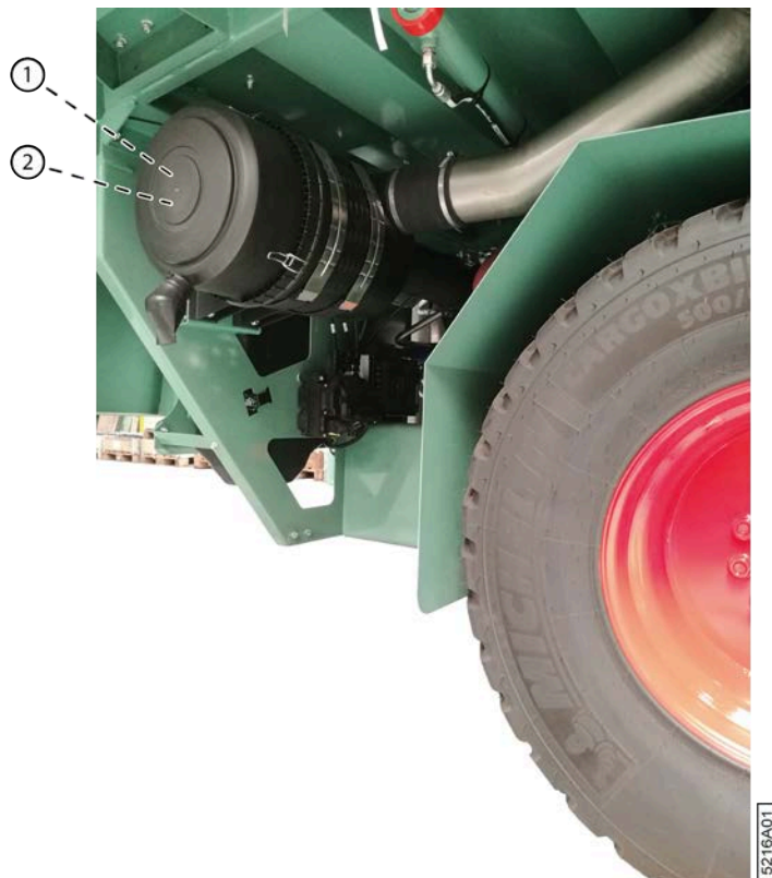
Fig. 181: Élément principal et élément de sécurité du filtre à air
