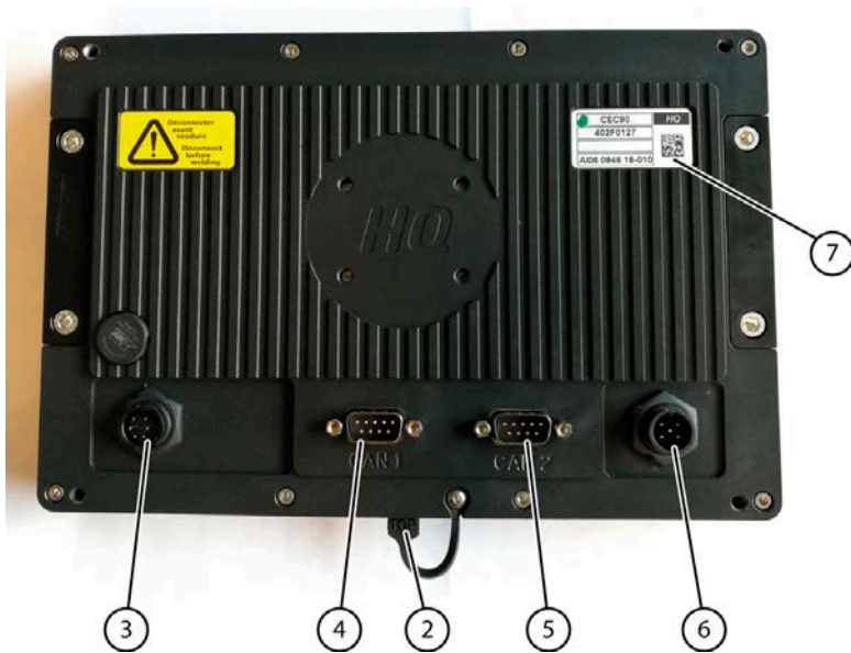
Fig. 61: Face arrière de l'écran de commande
