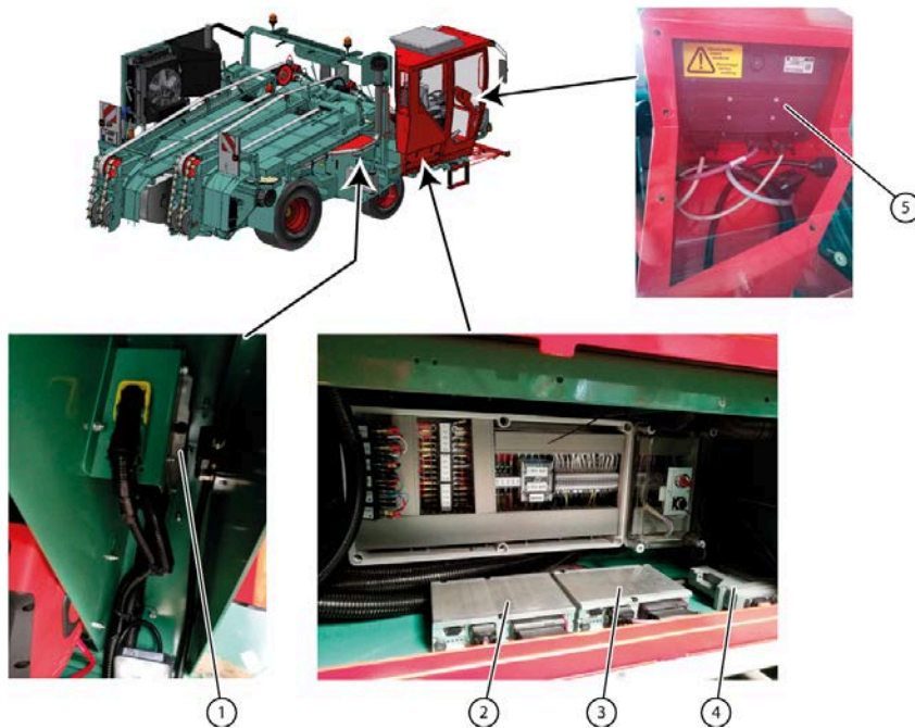
Fig. 28: Emplacement des contrôleurs
