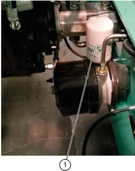
Fig. 116: Remplacer le filtre d'aération du frein de parking
