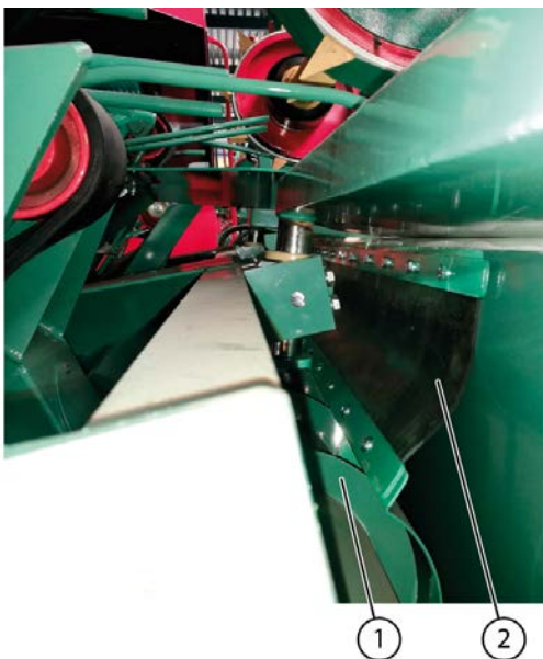
Fig. 140: Vérifier l'état du rabat en caoutchouc sur le vérin
