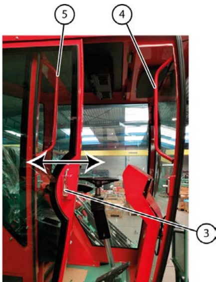
Fig. 10: Porte à l'extérieur de la cabine
