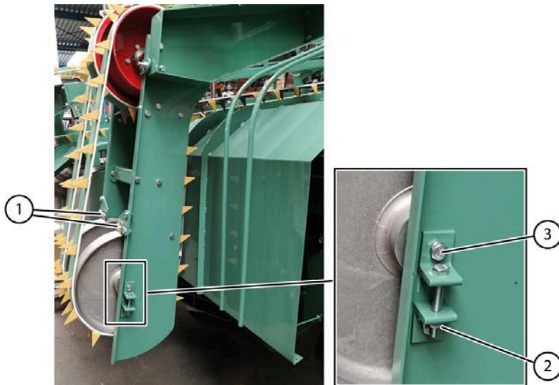
Fig. 94: Régler la tension des courroies de dépôt
