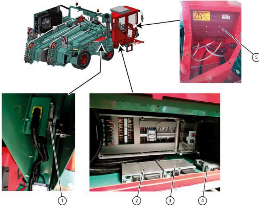
Fig. 167: Emplacement des contrôleurs
