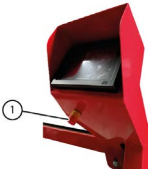
Fig. 44: Emplacement de l'arrêt d'urgence
