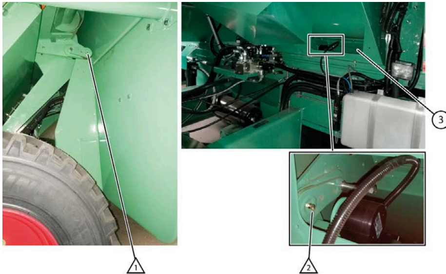
Fig. 142: Lubrifier les points charnières de l'arracheur
